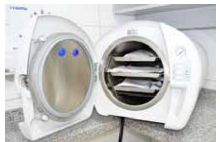
El equipamiento de la fotografía es un Autoclave, es un dispositivo que se usa para la esterilización del instrumental por medio del vapor a alta temperatura y presión.
